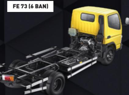
Mesin 4V21 dengan sistem Common Rail mampu menghasilkan torsi dan tenaga maksimal di putaran mesin yang rendah.
